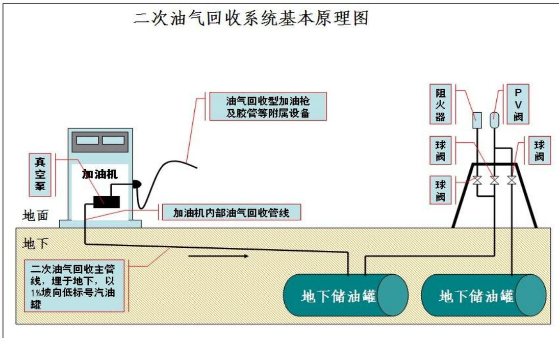
图 2.5-5 二次油气回收系统基本原理图
