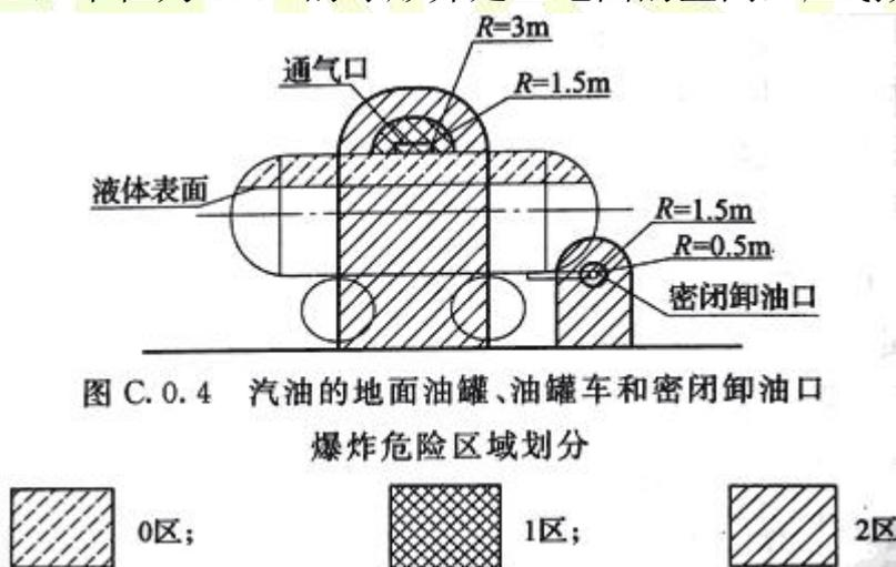
图 3.10-3 油罐车卸汽油爆炸危险区域
