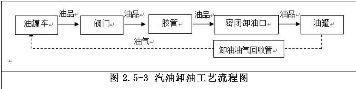
图 2.5-3 汽油卸油工艺流程图
