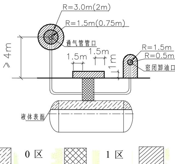
图3.10-1 埋地卧式汽油储罐爆炸危险区域划分
