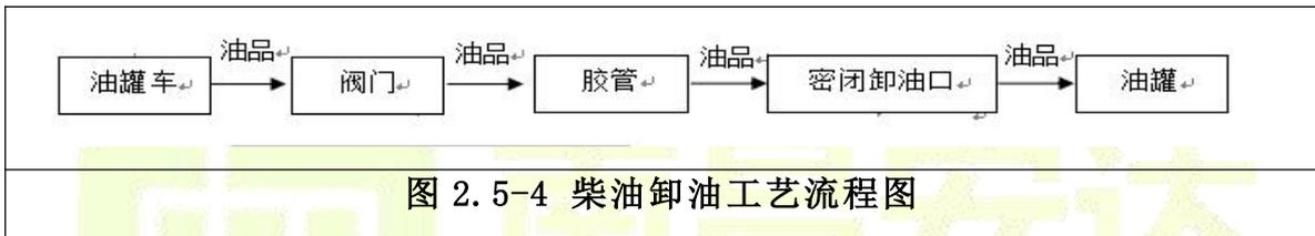
图 2.5-4 柴油卸油工艺流程图
