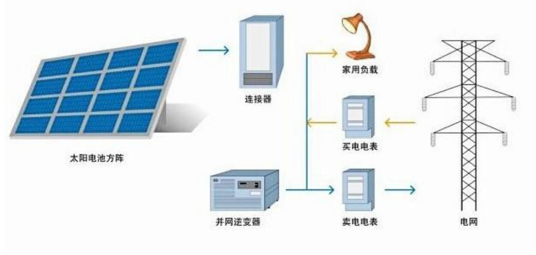
图 2.6-6 光伏发电工艺流程图
