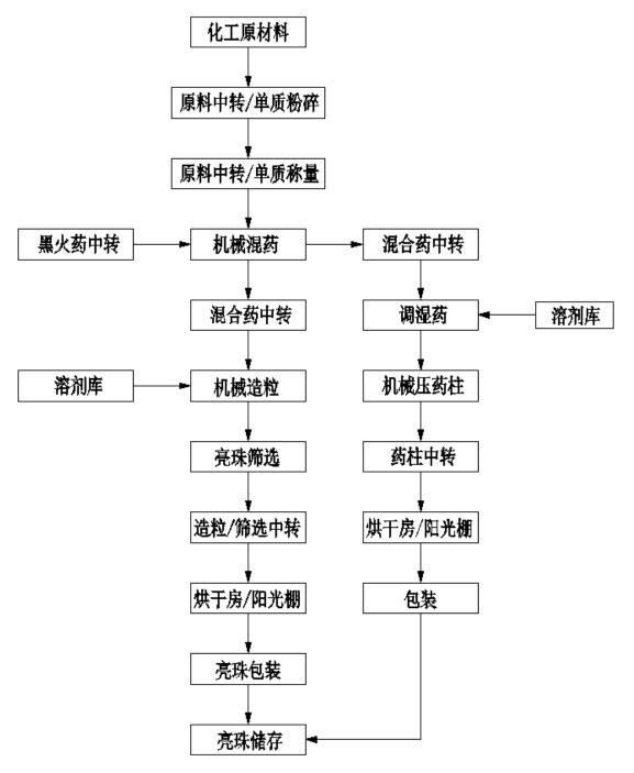
图 2.4-2 烟火药制作生产工艺流程图
